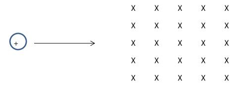
12. Calculer le rayon de la trajectoire par une particule alpha (charge de  $3.2x10^{-19}$ C et une masse de  $6.7x10^{-27}$  Kg) envoyée à une vitesse de  $4 \times 10^5$ m/s dans un champ magnétique de  $1.5 \times 10^{-3}$  T.
